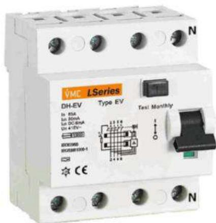
Différentiel triphasé 4 pôles (3P+N) 40A 30mA (0.3A) classe A + 6mA DC permet la protection des bornes de recharge des véhicules électriques. Détection de courant de fuite AC et AC avec composante DC. Il détecte les courants de défaut avec une composante continue supérieure à 6mA.
